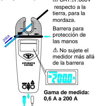
La mordaza acepta cables hasta calibre 1/0 (cobre)(diámetro máximo: 12,7 mm / 0,5")
